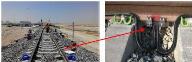
**Figura 70 Sistema WIM –WFD installato su rotaia**
