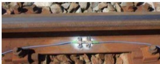
**Figura 45 Rotaia con sensore FBG**
